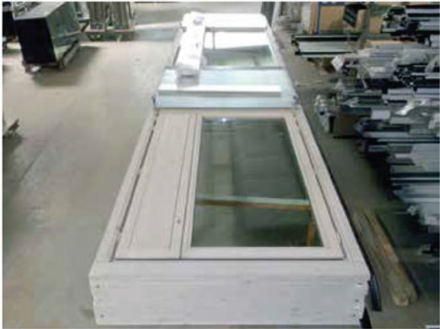
▲ Les rainures sur la face extérieure des cadres en épicea sont destinées à accueillir les joints EPDM, posés à l'avancement avec de l'eau savonneuse.
